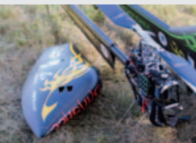
Auch der Heckausleger bekam eine superleichte, aerodynamische Vollverkleidung, deren Profilschnitt hier gut erkennbar ist
