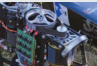
Blick auf die erste Getriebestufe. Der drehmomentstarke Okon-Motor Powercroco 5035 EVO (mehr Details unter www.powercroco.de) sorgt für einen kraftvollen, aber sparsamen Antrieb
