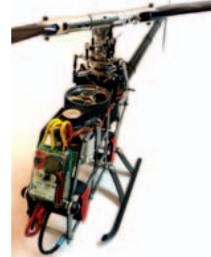
Frontseitig angeordnet ist der Controller, der auf kürzestem Weg mit den Motoranschlusskabeln verbunden ist
